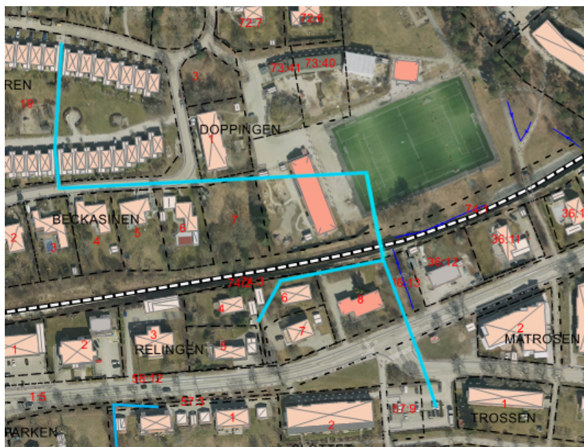
Figur 10: Spillvattenledningar i behov av uppdimensionering.
